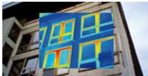
Jednostruki prozor loših izolacijskih svojstava
