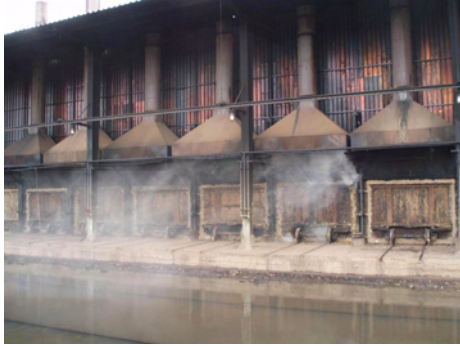
Slika 3. Proizvodnja drvenog ugljena u retortama u Beli– u (snimio J. Domac)
