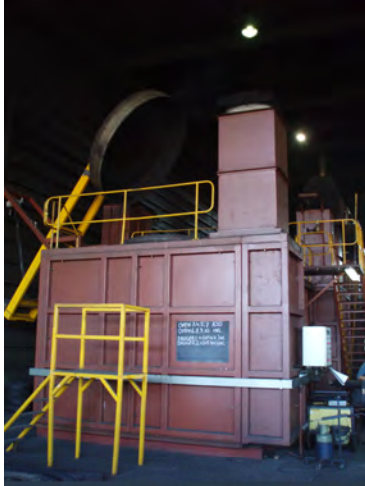
Slika 4. CARBO - suvremeni pogon za proizvodnju drvenog ugljena u Almelu, Nizozemska (snimio J. Domac)
